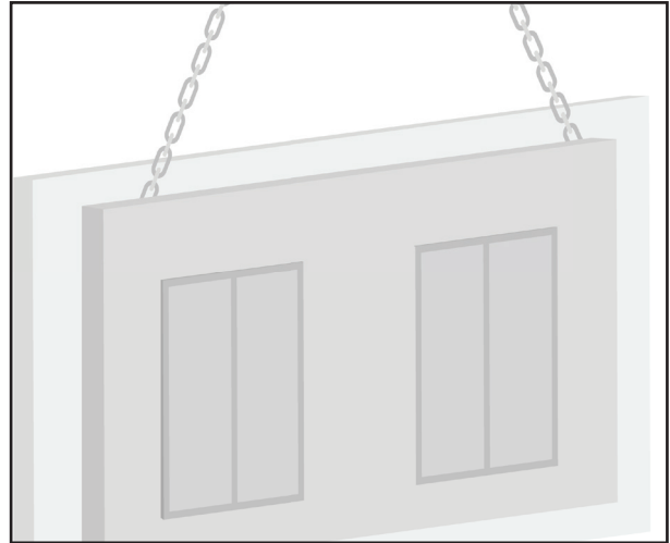
Abb. 2 Verwendung der Ausgleichsgehänge bei stehender Anlieferung
