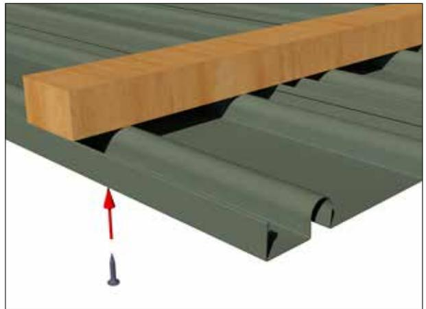
Die Profile können mit Schnellbauschrauben o.ä. durch die Hohlkehle an der Unterkonstruktion befestigt werden.
