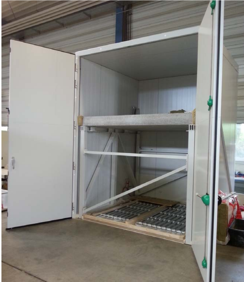
Bild 3: Geöffneter Deckenprüfstand mit installierter Messtechnik sowie Dämmung des Versuchskörpers
