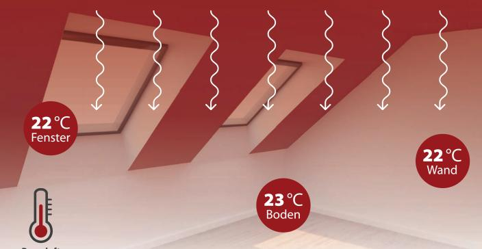
Die Technik basiert auf dem Strahlungsaustausch zwischen einer warmen und einer kalten Fläche. Die Wärme "von oben" strahlt sanft an die unten liegenden Körper ab (Fußboden/Wand/Möbel). Diese nehmen die Energie auf und erwärmen sich dabei.
